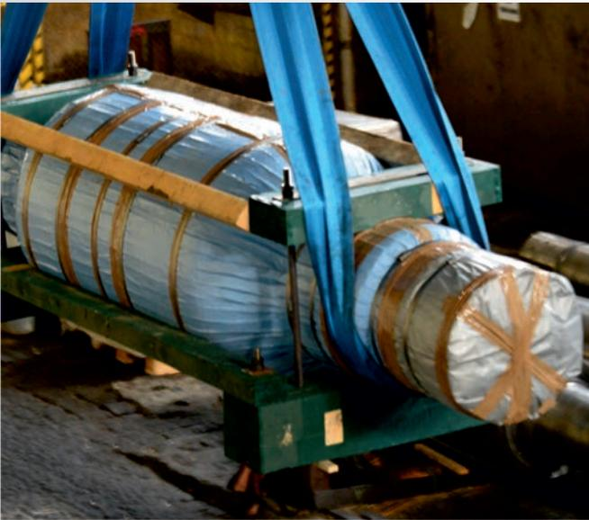
Перед отгрузкой валки подвергаются антикоррозийной обработке путем покрытия ингибитором, парафинированной бумагой и полиэтиленовым материалом.
