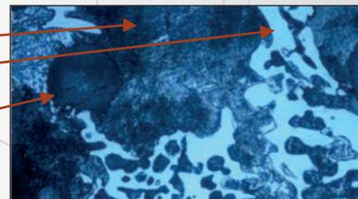
Микроструктура валков исполнений СШХ2НМ с твердостью 65-70 HSc – бейнито-карбидная с шаровидным графитом
