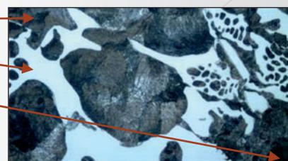
Микроструктура валков исполнений СШХ2НМ с твердостью 55-60 HSc – перлитно-карбидная с шаровидным графитом
