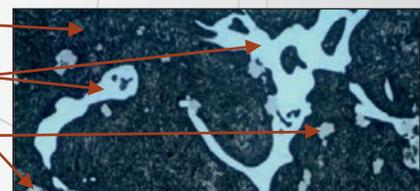
Микроструктура сердцевины и шеек валка: высокопрочный литой чугун с шаровидной формой графита. Твердость шеек 35-45 HSC. Material of roll neck and core is cast iron with nodular graphite. Hardness of the necks is 35-45 HSC.
