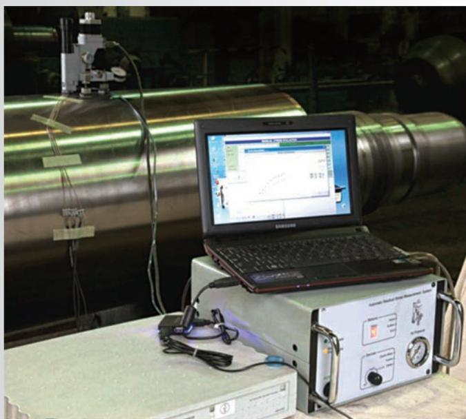
В процессе механической обработки контролируется структура рабочего слоя валка и шеек, распределение графита, определяются твердость и механические свойства материала валка.
